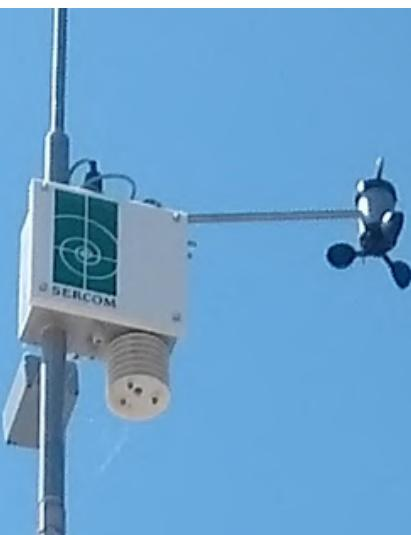
Метеостанция подходит для всех компьютерных систем Sercom. Наиболее важным отличием этой метеостанции от метеостанции SC800 является точность измерения ветра. Это позволяет управлять теплицами с одного (или нескольких) климатических компьютеров (с разной ориентацией конька).
