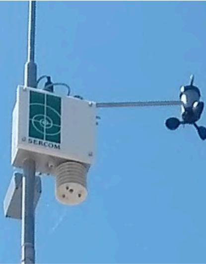
Die Wetterstation ist geeignet für alle SKOV-SERCOM Prozesscomputersysteme. Der hauptsächliche Unterschied mit der SC800 Meteostation ist die Genauigkeit der Windmessungen, wodurch es möglich wird mehrere Gewächshäuser anzusteuern von einem (oder mehreren) Prozesscomputer(n) (mit unterschiedlichen Gradausrichtungen der Häuser).
